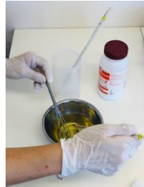
オイルと苛性ソーダー溶液の温度を合わせる。
